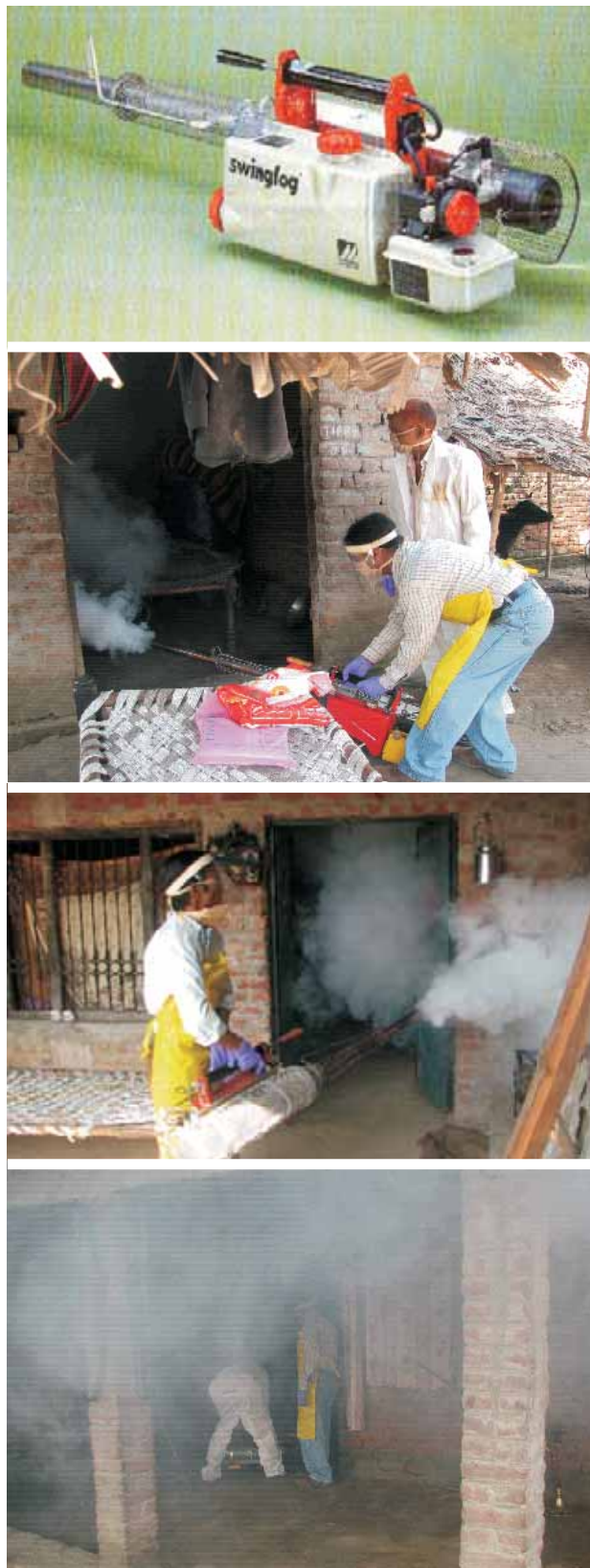
Fig. 21. Cyphenothrin fogging using swingfog machine
